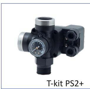
Pressostat mécanique traditionnel PS2+ intégré dans un raccord 3 voies avec clapet anti-retour interne et manomètre.
