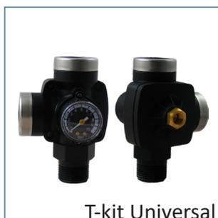
Rácor de 4 vías con válvula anti-retorno interna y manómetro incorporado. Dispone de una toma G1/4" hembra en latón para roscar un manómetro, un transductor o un adaptador a cualquier otro tipo de rosca.
