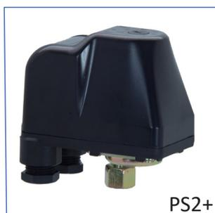
Presostato mecánico tradicional para el control de electrobombas de hasta 1,5 kW (2HP), tensión de alimentación monofásica 110÷230V, con grado de estanqueidad IP54 y conexión G1/4" hembra giratoria para facilitar el montaje.
