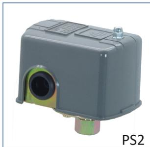
Presostato mecánico tradicional para el control de electrobombas de hasta 1,5 kW (2HP), tensión de alimentación monofásica 110÷230V, con grado de estanqueidad IP20 y conexión G1/4" hembra.
