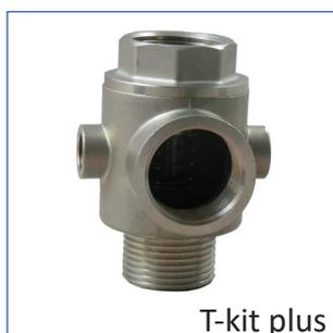
Rácor de 5 vías en acero inoxidable con válvula anti-retorno interna. Ideal para sistemas con tanque hidroneumático, con dos entradas para manómetro y elemento sensor (transductor, presostato, ...).
