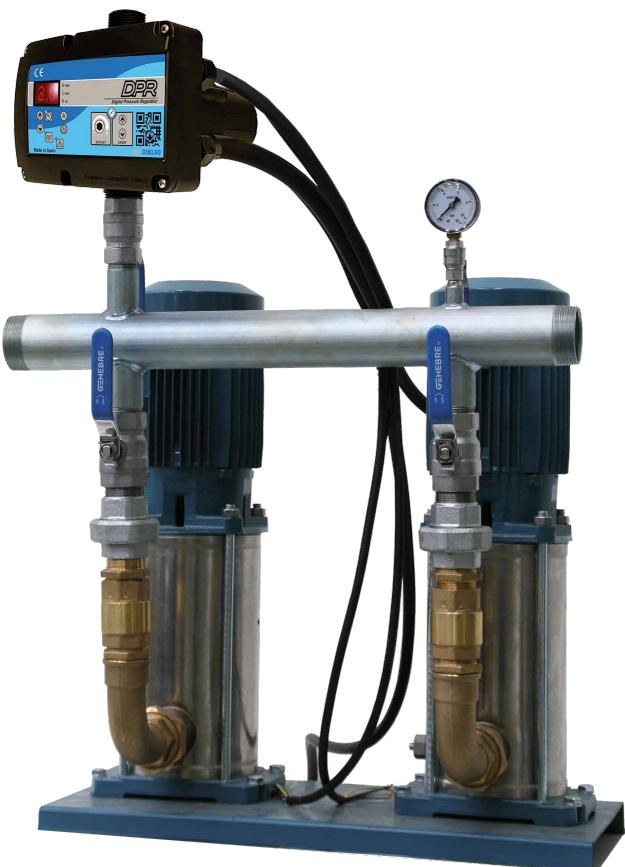
Un sistema duty-standby di 2 pompe può essere facilmente impostato con il nostro dispositivo **DPR alt**, gestendo 2 pompe monofase con funzionamento alternato - non funzioneranno mai simultaneamente - e una pressione costante in uscita. Questo sistema garantisce la fornitura di acqua in caso di guasto di una delle pompe e ne aumenta la longevità.
