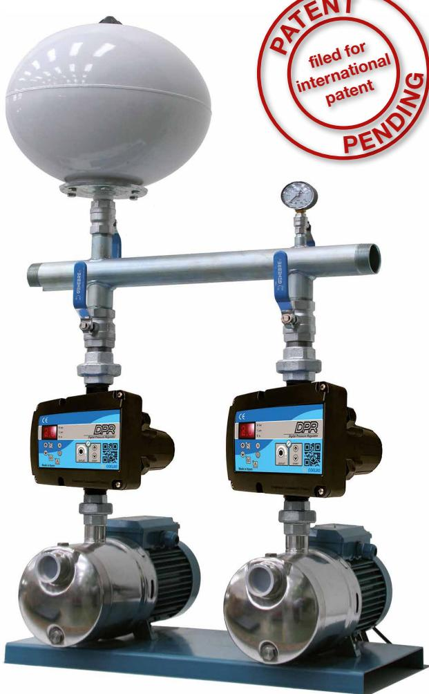
Si può facilmente ottenere un sistema duty-assist collegando 2 unità **DPR master**, gestendo 2 pompe monofase a cascata e con sequenza di avviamento alternata, a pressione costante.
